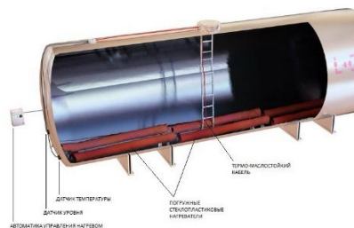
Рисунок 3.7 – Цистерны с теневой защитой и «паровой рубашкой» для перевозки нефтепродуктов
