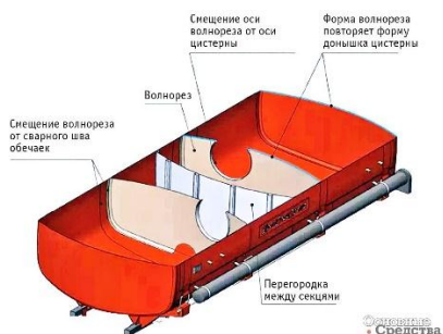
Рисунок 3.8 – Внутренняя часть цистерны для перевозки нефтепродуктов
