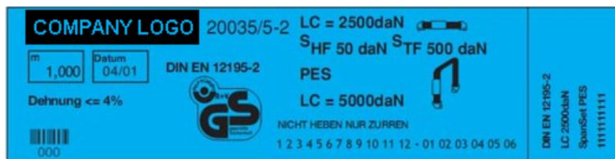
Рисунок 7.9 – Примеры маркировки на натяжных ремнях (допустимая рабочая нагрузка (LC) в даН; стандартная ручная сила ( S_{HF} ); сила предварительного натяжения ( S_{TF} ) в натяжном рычаге в даН, при креплении прижимом)
