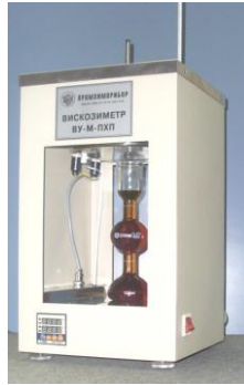
Рисунок 1.13 – Вискозиметр – прибор для измерения вязкости
