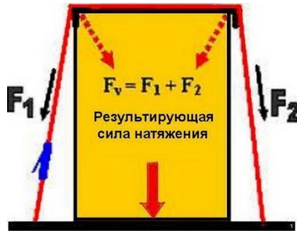
Рисунок 7.4- Силы крепления прижимом
