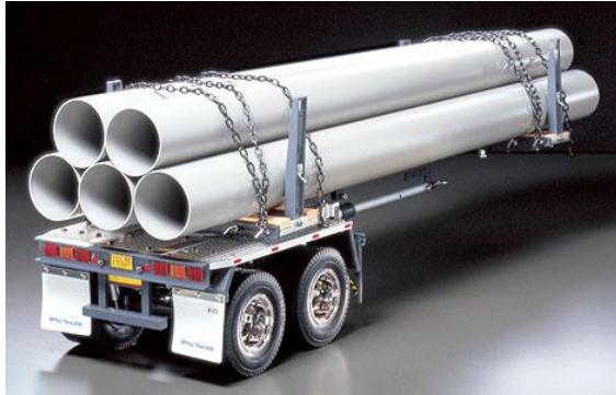
Рисунок 2.25 – Пример укладки и крепления труб.
